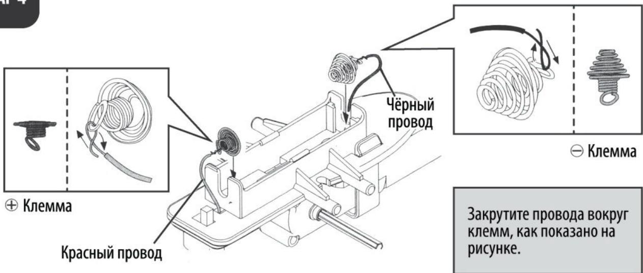
Закрутите провода вокруг клемм, как показано на рисунке.
